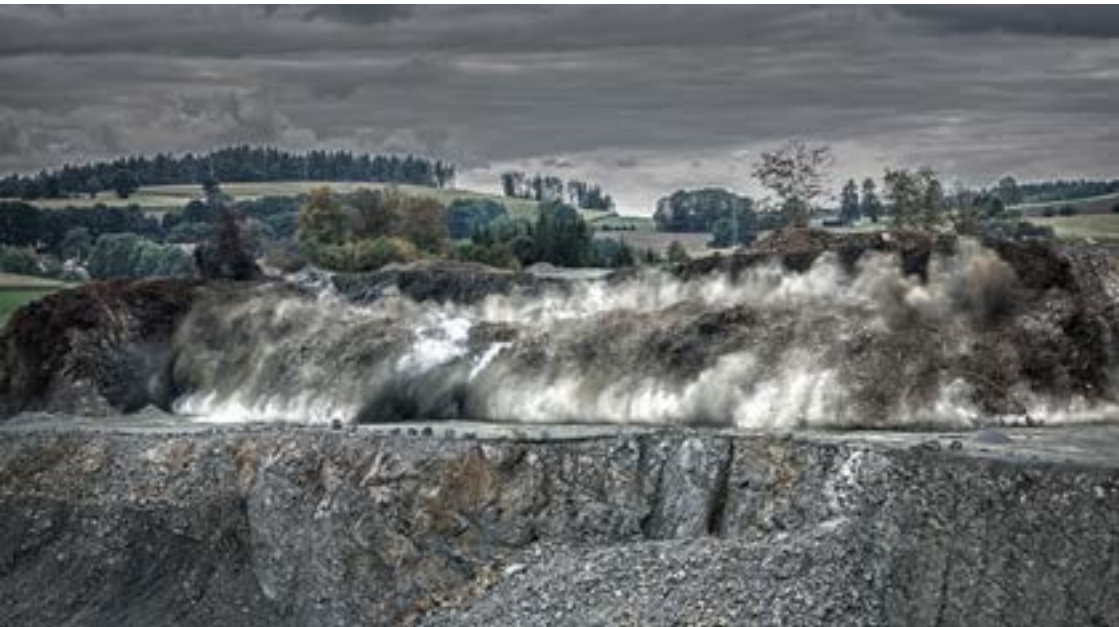
Abbildung 4: Diabashaufwerk wird durch Sprengung für vielfältige industrielle Anwendungen gewonnen. (Foto: Schicker)
