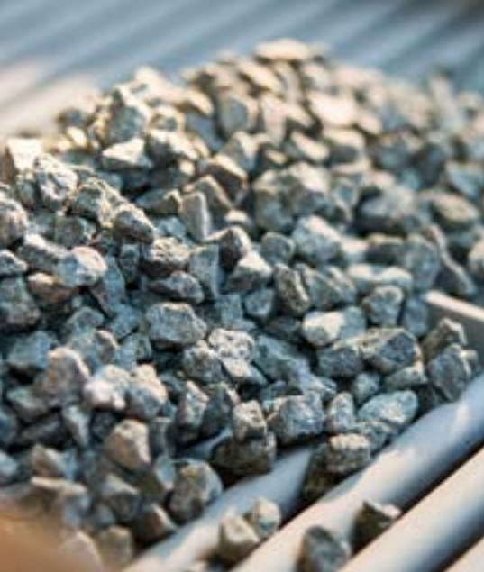
Abbildung 2: Sauber aufbereitet: Sorgsam abgestimmte Prozesslinien in den Werken sorgen für hochwertige kubische Körnungsprodukte. (Foto: Pescher)
