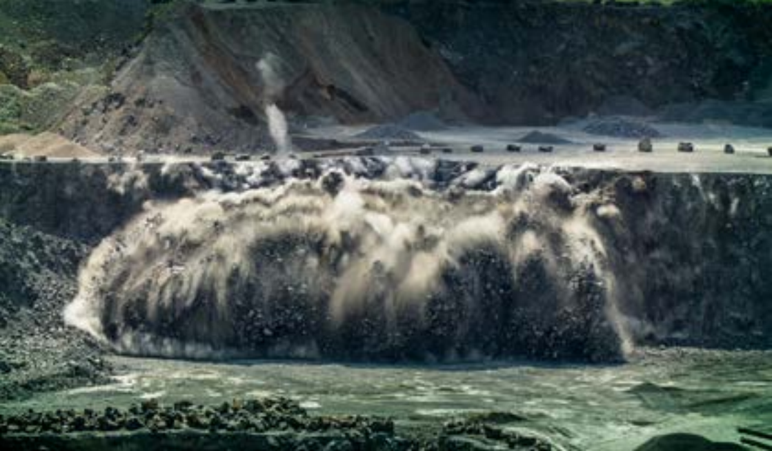
Abbildung 6: Der Diabas wird durch Sprengen aus dem Gesteinsverband gelöst. Danach durchläuft das Gestein einen mehrstufigen Aufbereitungsprozess.
