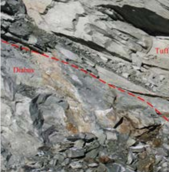
Abbildung 3: Diabastuff überlagert kompakten Diabas (Steinbruch Reimersgrün).
