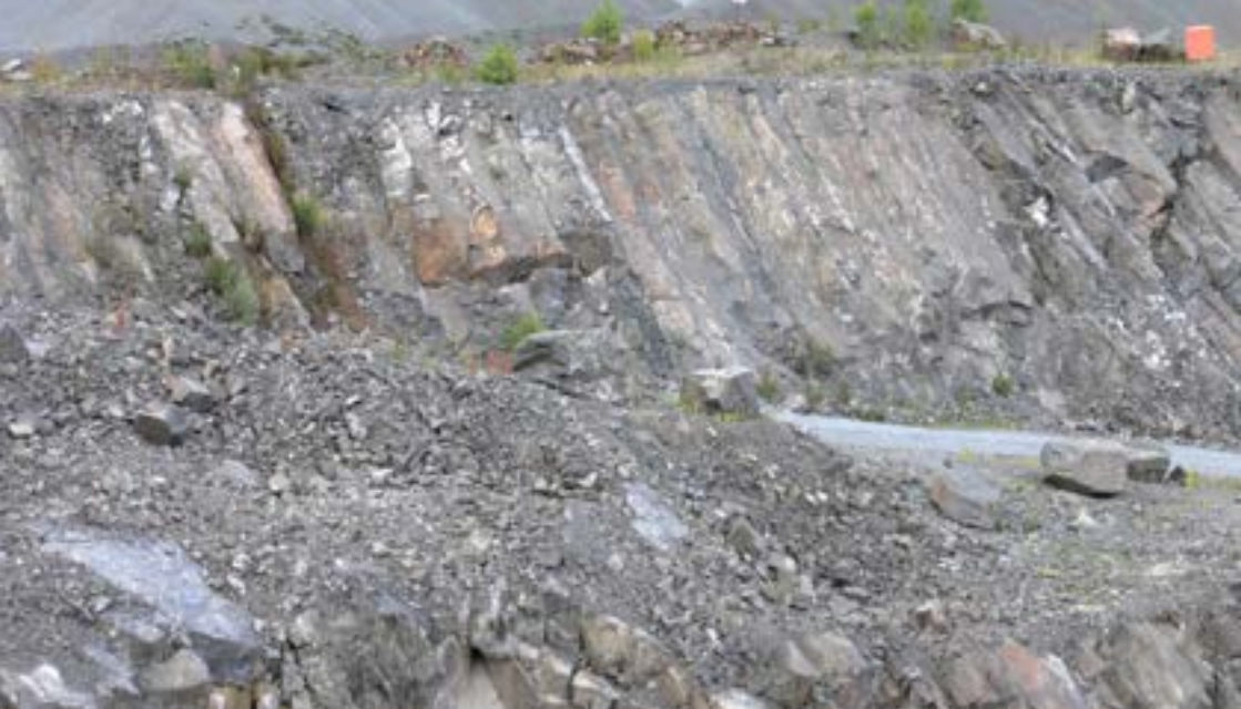
Abbildung 7: Steinbruch Burgk-Möschlitz: Blick auf die mehrere Meter hohen Diabassäulen im Nordteil, Strossenhöhe in der Bildmitte etwa 5 Meter.
