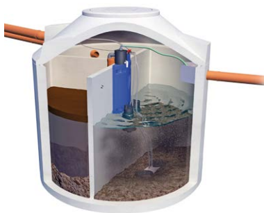
Bild 5: Sequencing Batch Reactor mit Pumpe
