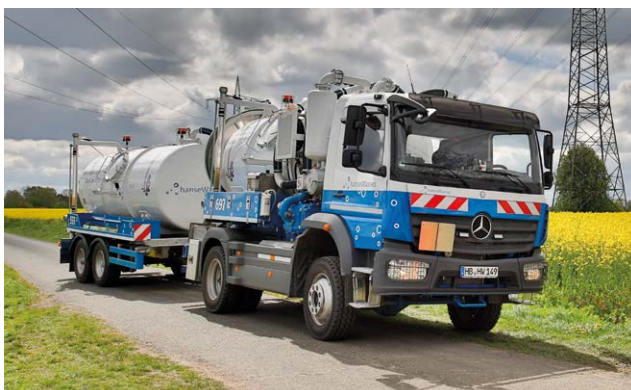
Bild 2: Saugwagen zur Entschlammung von Kleinkläranlagen
