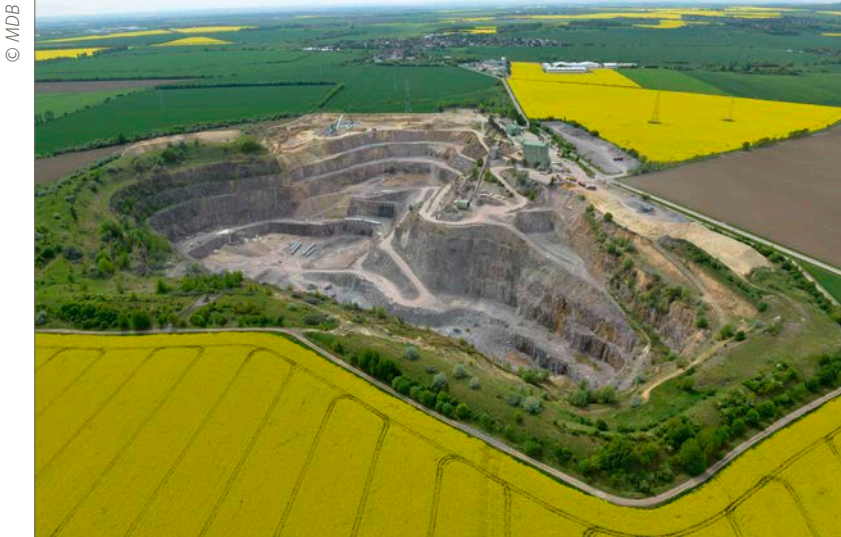
Abb. 2: Rohstoffgewinnung im Steinbruch – Deutlich zu erkennen sind die im Böschungsbereich entstehenden Vorratsverluste
