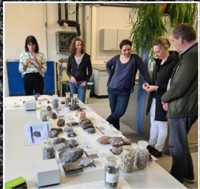
Die Teilnehmenden bestimmten u.a. magmatische Gesteine oder sahen eine Schlagzertürmmerungsuntersuchung von Gestein zur Bestimmung des Los-Angeles - Koeffizienten (u.I.). | Fotos: Albrecht Wiehe, UVMB
