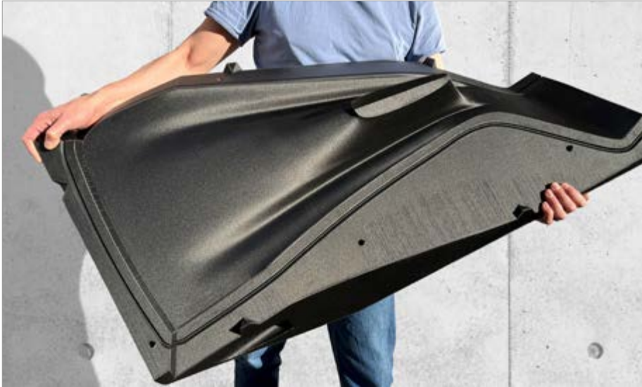
▲ Durch die 3D-gedruckte Schalung wird eine hohe Präzision bei den einzelnen Treppenstufen erreicht. Bild: New Digital Craft
