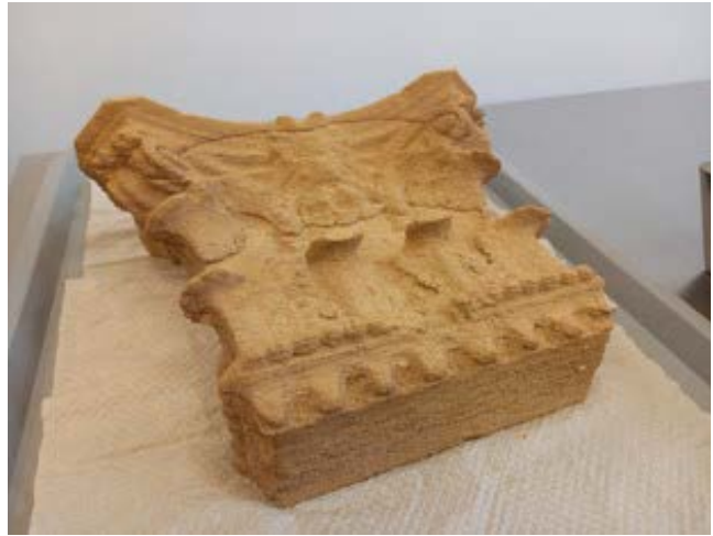
▲ Säulenkapitell aus Steinrestauriermörtel mittels 3D-Druck gefertigt
