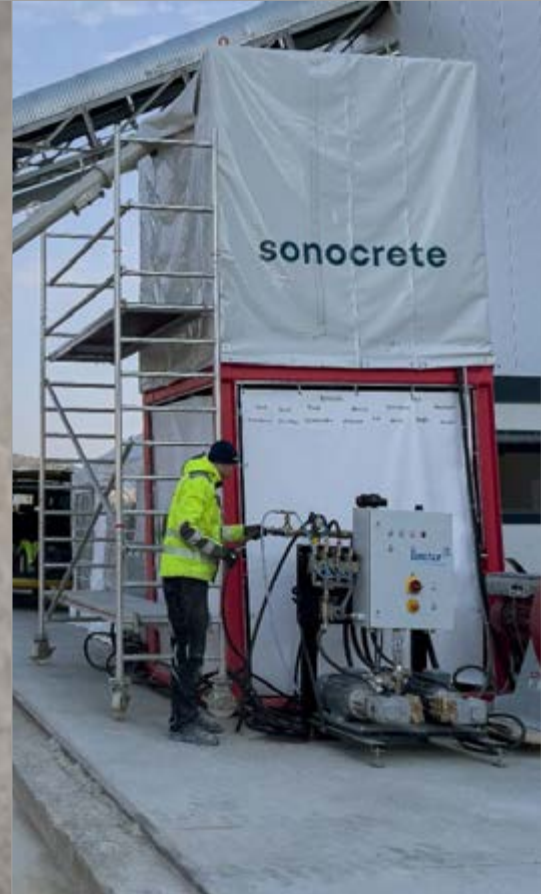
▲ Der Sonocrete-Effekt: Mithilfe von Hochleistungsultraschall wird eine bessere Früh- und Kompressionsfestigkeiten bei Fertigbetonen mit geringem Klinkeranteil erreicht. | Foto: Sonocrete
