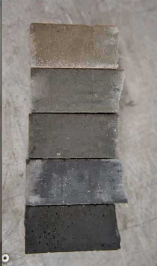
▲ Gebäude als Kohlenstoffsinken: ecoLocked entwickelt klimafreundlichen Beton durch die Integration von Zuschlägen aus Biokohlenstoff, einem CO 2 -negativen Material. | Foto: ecoLocked
