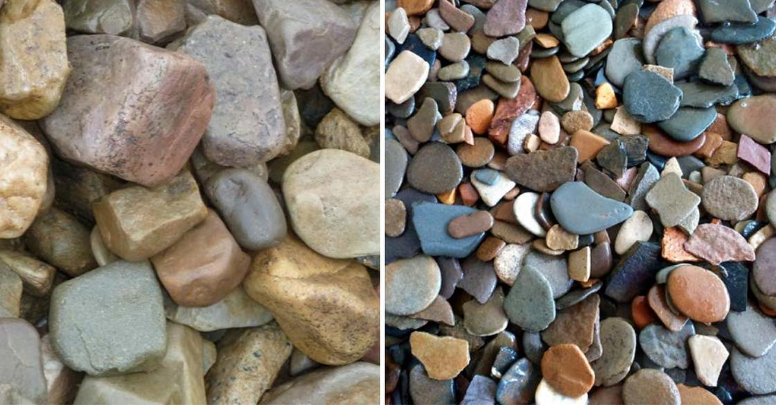
**Abbildung 2:** Bereits optisch unterscheiden sich die einzelnen Kiese nach ihrem Liefergebiet bzw. den Bedingungen zum Zeitpunkt der Ablagerung; links: bunte Kiese aus dem Elbe-Gebiet; rechts: bunte Kiese aus der Helme-Niederung, die überwiegend aus plattigen, teilweise schiefriigen Geröllen aus dem Harz und dem Kyffhäusergebiet bestehen.
