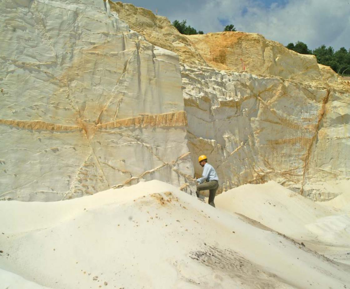
**Abbildung 6:** Oberflächennah verwitterte Kreidesedimente im Tagebau Weferlingen. Die sehr gleichkörnigen Quarzsande werden vorrangig in der Glas-, Gießerei- und Kunststoffindustrie verwendet.
