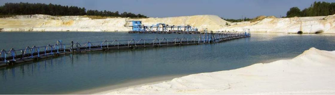
**Abbildung 2:** Gewinnung von hochwertigem Quarzsand durch Saugbaggerschiff im Quarzsandwerk Uhry der Schlingmeier Quarzsand GmbH & Co. KG (Foto: BGR).
