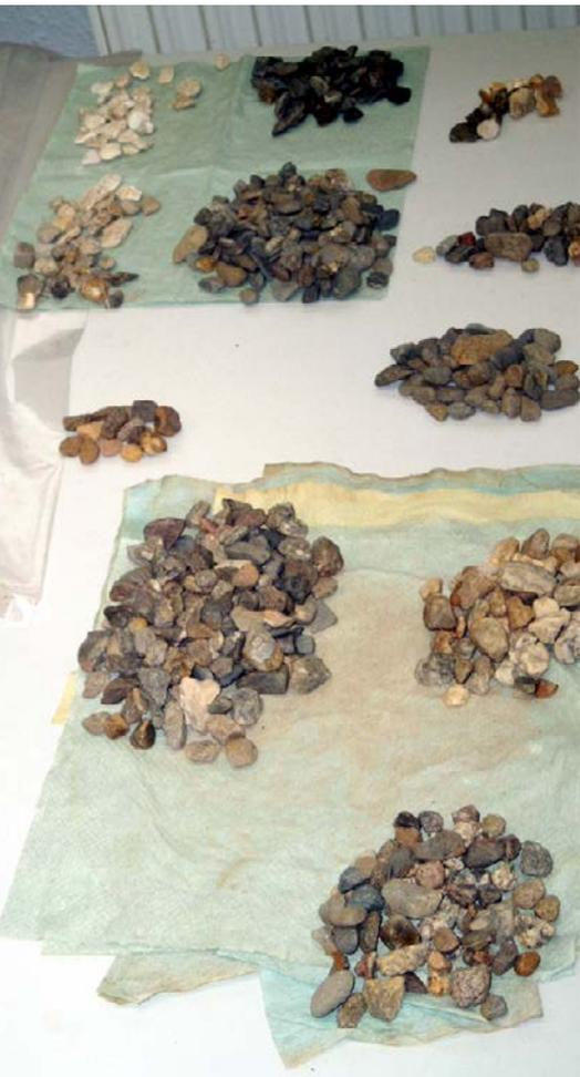
**Abbildung 4:** Petrographische Analyse der Fraktion 8 bis 16 Millimeter aus einer Kiesprobe. Der Geröllbestand wird dabei in einzelne Gesteinsarten bzw. -gruppen sortiert, die gleiche bzw. ähnliche gesteinsphysikalische Eigenschaften aufweisen. So zeichnen sich beispielsweise Quarz und Quarzite durch hohe Festigkeiten aus, während Ton- und Schluffsteine bei mechanischer Beanspruchung häufig zerbrechen.
