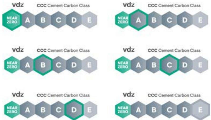
Beim neuen CO<sub>2</sub>-Label des VDZ wird die Klassifizierung klimafreundlicher Produkte wie folgt umgesetzt: Die Klassen A bis D kennzeichnen emissionsreduzierte Zemente mit einem CO<sub>2</sub>-Fußabdruck zwischen 100 kg CO<sub>2</sub>/t Zement und 500 kg CO<sub>2</sub>/t Zement in vier Stufen. Als „Near Zero“-Zemente gelten solche mit einem CO<sub>2</sub>-Fußabdruck von weniger als 100 kg CO<sub>2</sub>/t Zement.
