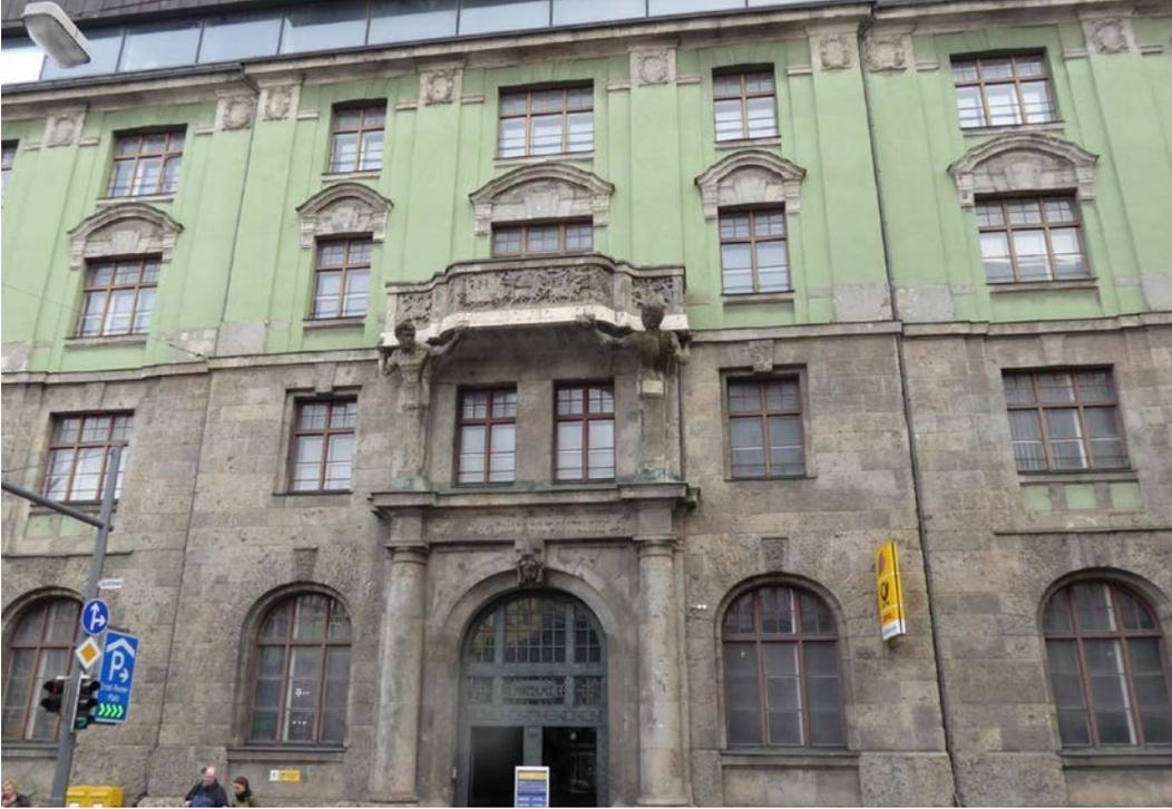
**Abbildung 3:** Post in der Grottenau in Augsburg, EG und 1. OG aus Suevit, der Sockel besteht aus Nagelfluh, der nördlich von Augsburg gewonnen wurde (Foto: Klaus Poschlod).
