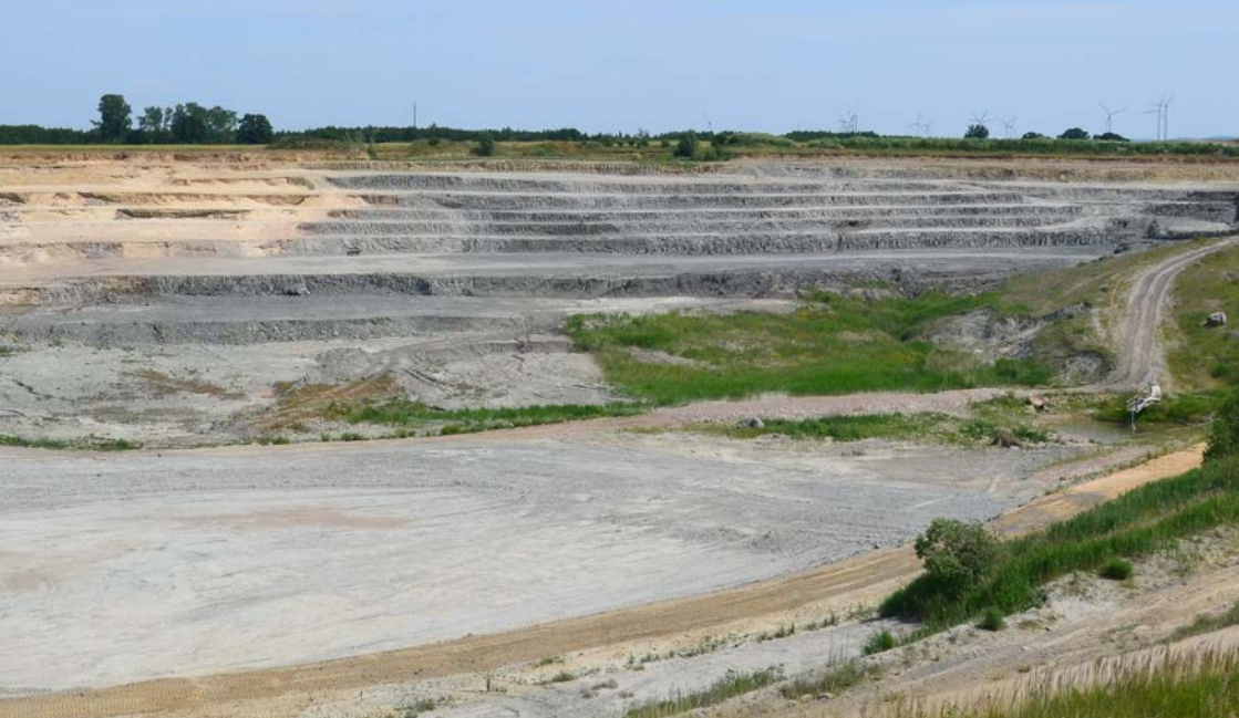
Abb. 2: Blick in den Tontagebau Friedland, Stand 2022. Im Tagebau sind die eozänen Tone (dunkelgrau) zusammen mit saalezeitlichen Geschiebemergeln (hellgrau bis hellbraun), Sanden und Schluffen (gelb) verschuppt. .
