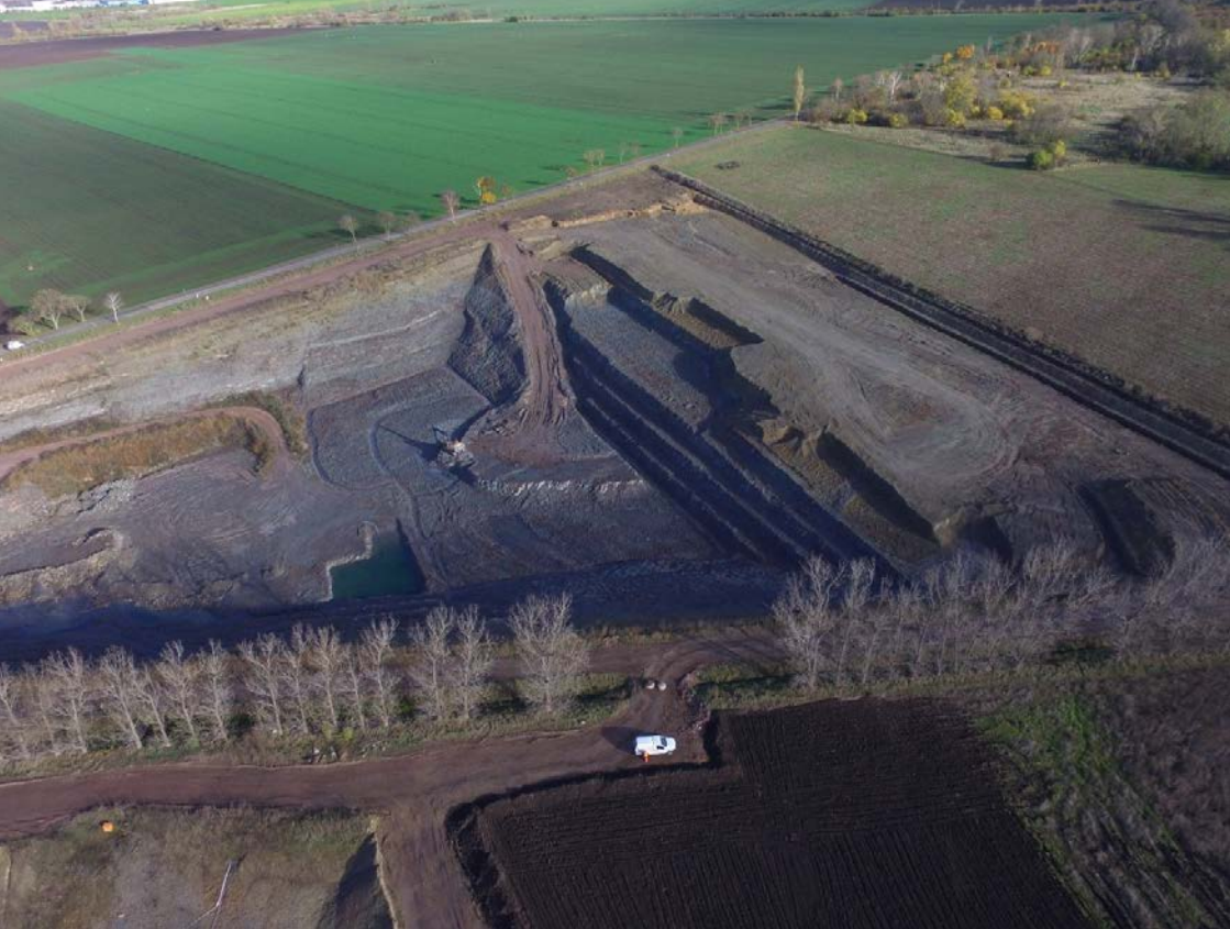
Abb. 6: Blick in den Tagebau Peißen (b. Bernburg). Die hier anstehenden Ton- und Schluffsteine werden vorrangig im Deich- und Deponiebau eingesetzt. Der aufgeschlossene Bereich entspricht der Begrenzung der derzeit erkundeten Lagerstätte (Foto: Peißener Tonprodukte GmbH + Co KG).
