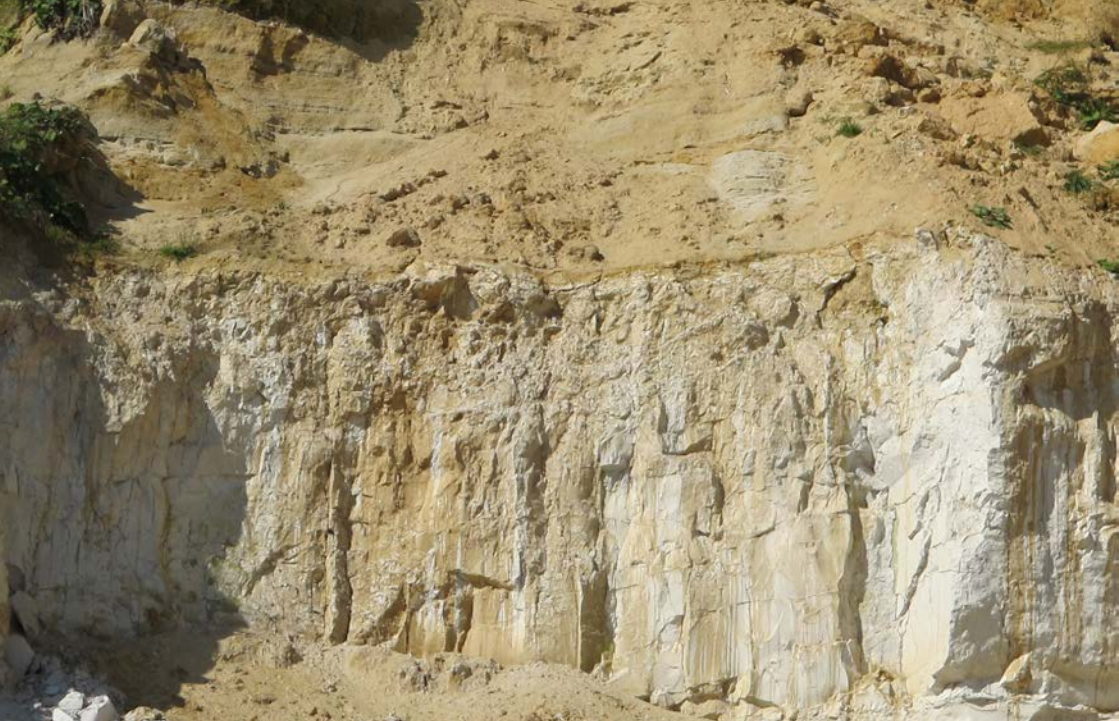
Abb. 2: Abbauwand des „Frohnsdorfer Tons“ im gleichnamigen Tagebau mit überlagernden Kiessanden. Beide Lockergesteine werden am Standort in Frohnsdorf gemeinsam gewonnen (Foto: TLUBN).
