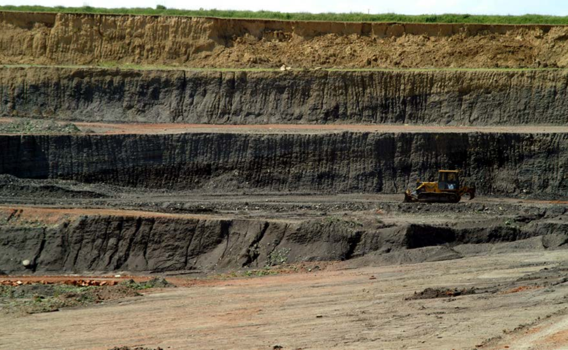
Abb. 5: Tontagebau Wefensleben. Die gebänderten Ton- und Schluffsteine des Unteren Lias sind bis zu 30m mächtig. Sie werden im Ziegelwerk Wefensleben vorrangig zur Herstellung von Hintermauer- und Schornsteinziegeln eingesetzt. (Foto: LAGB, 2007).
