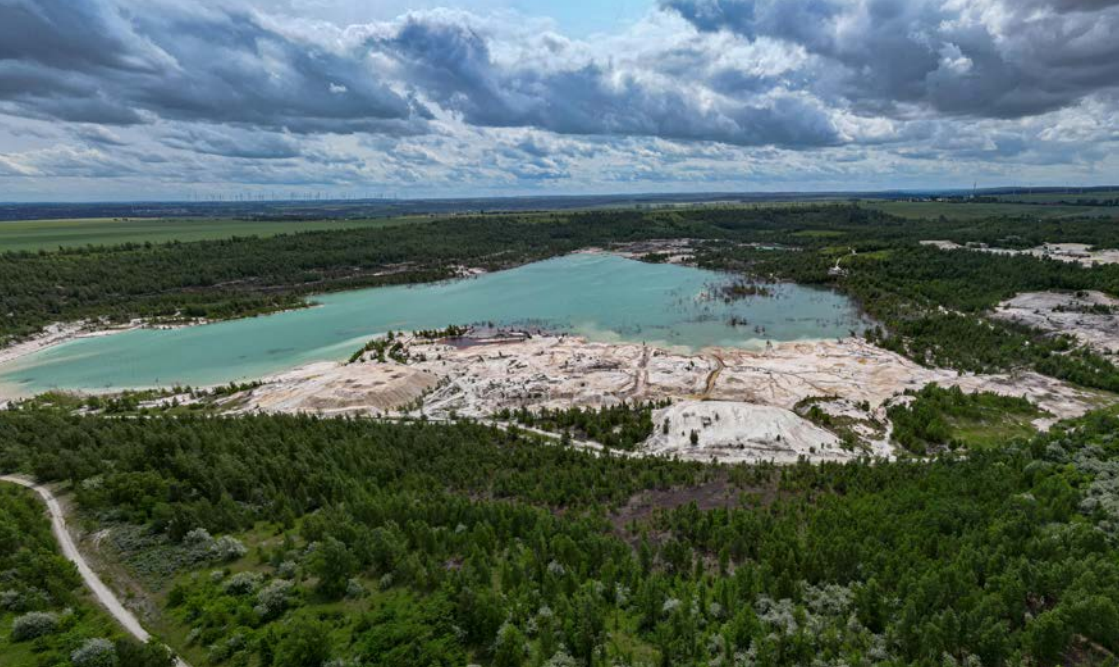
Abb. 4: Blick in den Tagebau Roßbach. Nach Einstellung der Wasserhaltung wird der Wiederanstieg des Grundwassers deutlich (Foto: Oliver Fox).
