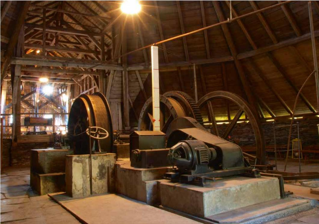
**Abbildung 5:** Innenansicht der original erhaltenen Göpelschachtanlage im Staatsbruch Lehesten. Die Anlage war zwischen 1846 und 1964 in Betrieb und veranschaulicht heute als Schaufenster „Industriegeschichte“ den technischen Fortschritt vom Pferdezug über Dampfantrieb bis hin zum Wechselstrom (Foto: Kevin T. Fischer).
