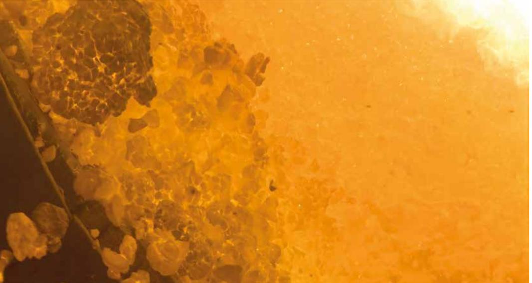
**Abbildung 2:** Blähprozess des Schiefers – Blick in den Drehrohrofen.
