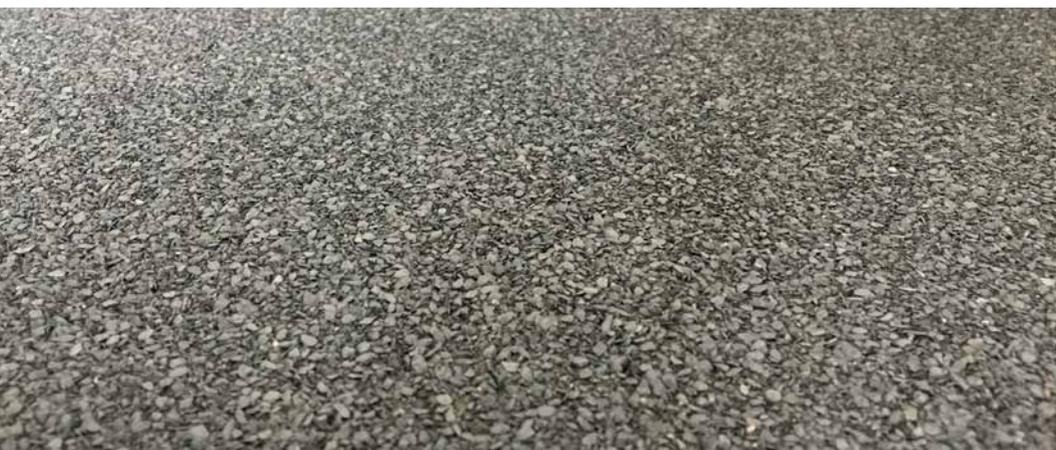
**Abbildung 3:** Oberflächenbestreung aus Schiefer für Dachbahnen.
